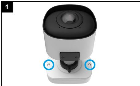
Lösen Sie die Schrauben und öffnen Sie die Anschlussbox.
