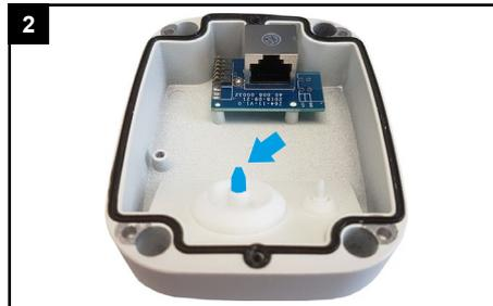
Drehen Sie die Spitze der dickeren Dichtung ab (hier blau markiert)
