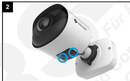
2 Lösen Sie die Schrauben vorsichtig, ohne sie zu verlieren und nehmen Sie den Deckel ab.
