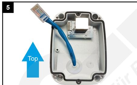
Positionieren Sie die Anschlussbox mit der Dichtung unten und der Anschlussplatine oben.
